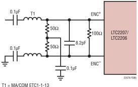
RESISTORS AND CAPACITORS ARE 0402 PACKAGE SIZE
